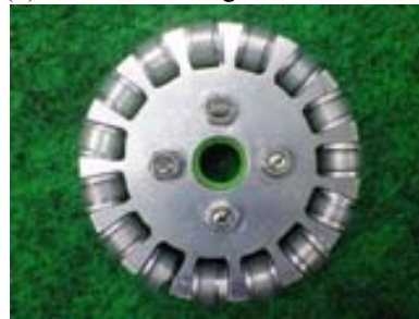
(d) with thick silicone rubber ring tires
